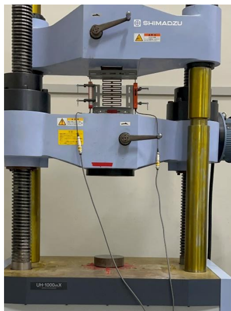
写真2 試験体設置状況（S-A試験体）
