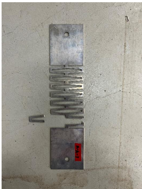
写真4 破断したA-A試験体
