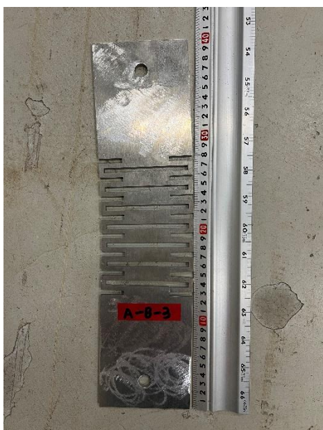
写真5 大きな曲げ変形の生じたA-B試験体
